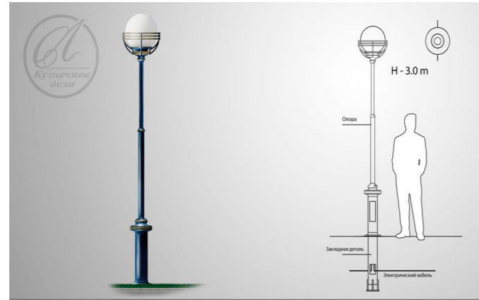
T/X по теме: Фонарь Лунь. H - 3.0 м. Грунт: - Эмаль 3в1 (антикоррозийный). Электрокомплектация: Для индивидуального подхода по теме T/X Опора: Сталь - (С15ПС, 08ПС). Краска: Forgent Paint (Синий). Е 27. контакт с производством Рассеиватель: Шар 400. Патина: WS - Patina (под Золото). ПВС 3Х1.5. тел. факс: (8652) 23 04 81. (Полим Сталь - (С15ПС, 08ПС). ЗНИ -16. (8652) 22 04 41.
